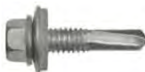
GTR8 Винт самосверлящий с органическим покрытием gRey.coat, с шайбой Z14 и прокладкой EPDM
